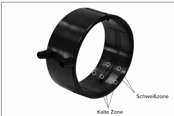
Abbildung 3.167 Akafusion Elektroschweißmuffe mit kalter Zone und Schweißzone
